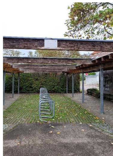
Abbildung 36: Anlehnbügel aus gebogenen Rohrelementen („Fahrrad-Parkschnecke“)
