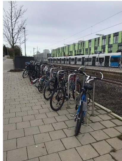
Abbildung 34: Anlehnbügel als Rundrohr ohne Querholm in Einzelaufstellung am Bahnhof Ditzingen
